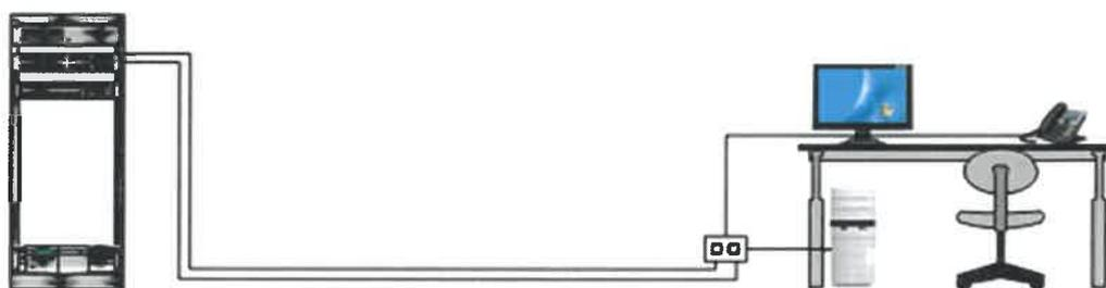
La distribuzione orizzontale identifica quella parte di cablaggio realizzata con cavo in rame a 4 coppie che collega i pannelli di permutazione di piano alle postazioni di lavoro utente mediante connettori modulari di tipo RJ45 per il rame.
